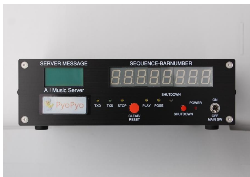
サーバーの表パネル
